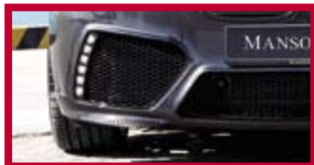
В новом переднем бампере из углепластика – светодиодные фары дневного света.
