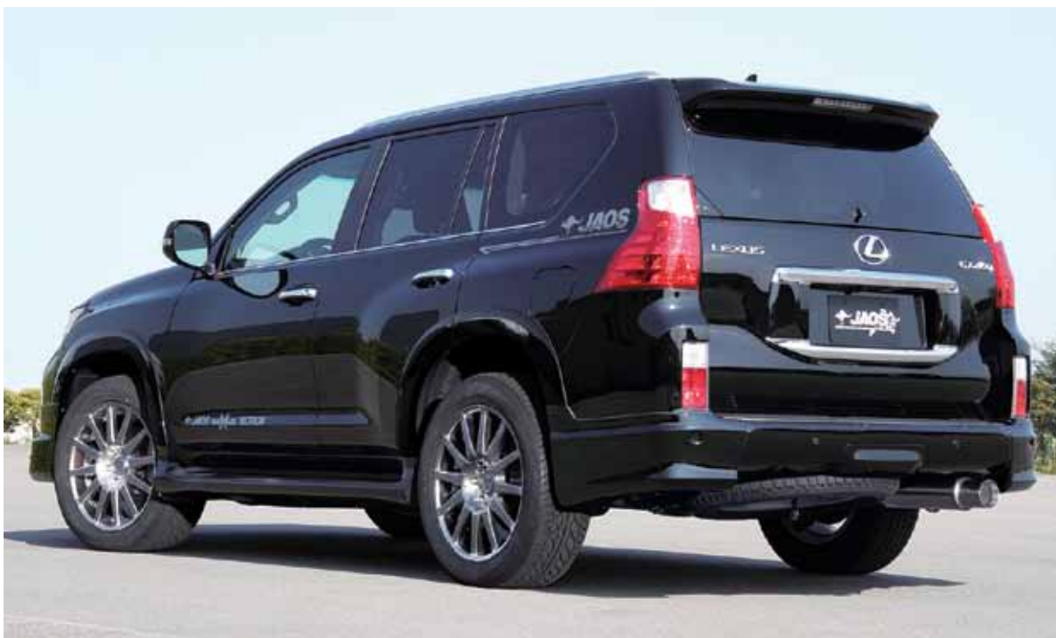
Спойлер заднего бампера состоит из двух частей, что позволяет при минимуме затрат существенно изменить корму автомобиля
