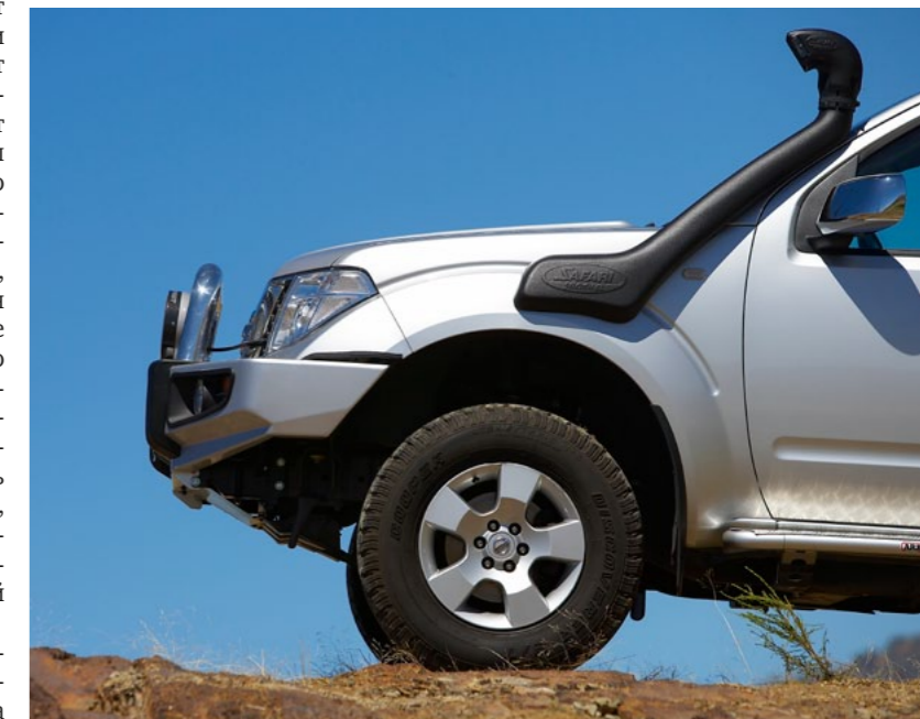
Выносной воздухозаборник на борту внедорожника – это не просто оригинальное украшение, а настоящая система жизнеобеспечения для мотора
