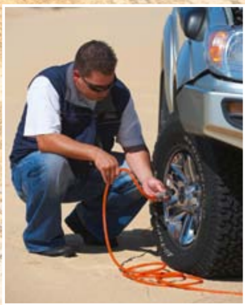
Для преодоления песков приходится снижать давление в шинах. Чтобы потом вернуть его в норму, можно использовать высокопроизводительный воздушный компрессор ARB, который также активирует межколесную блокировку
